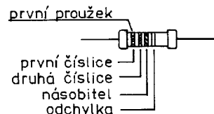
Obr. 13. Barevný kód rezistorů
