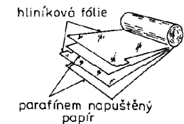
Obr. 19. Svitkový kondenzátor s papírovým dielektrikem
